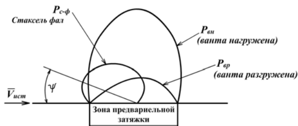
Рис. 4. Характер усилий в стоячем такелаже по курсам на регулярном волнении
