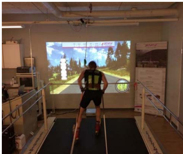
Рис. 3. Тестирование на лыжероллерном тредмиле с системой Athene (Nurkkala V., Kalermo J., Jarvilehto T., 2014)
